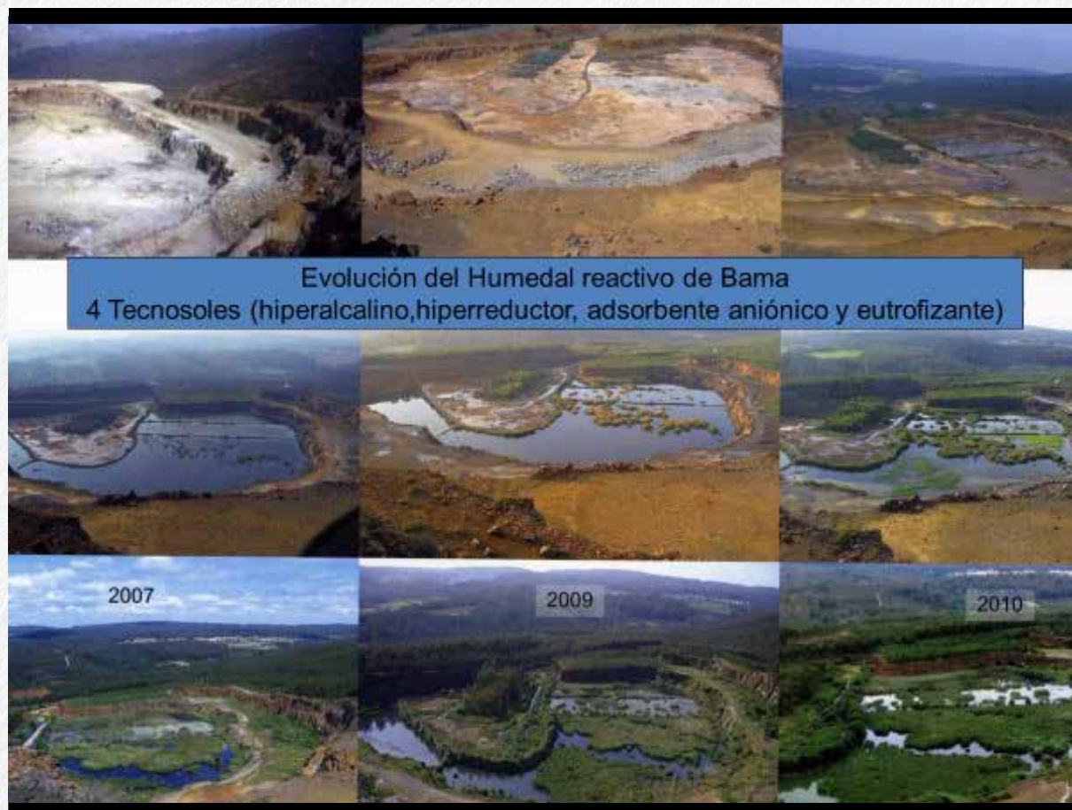
Fig. 3.- En el 2004, se inició la construcción del primer Humedal reactivo con 4 tipos de Tecnosoles en la mina de Touro. Corrigió las aguas hiperácidas de mina, llevándolas a un pH en torno a 7.0, con reducción de la concentración de sulfatos, Al y metales pesados disueltos a niveles tolerables para aguas potabilizables y la recuperación de la cadena trófica desde insectos acuáticos a predadores finales.
