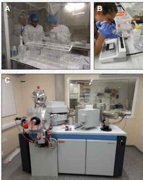
Figura 1. a) Columnas de cuarzo hechas a mano en el laboratorio limpio, para la separación del Sr de la matriz del vino. b) Colocación del extracto de Sr en el filamento de renio en 1 \mu L de disolución ácida de Ta_2O_5-HNO_3-HF . c) Imagen del equipo TIMS.
