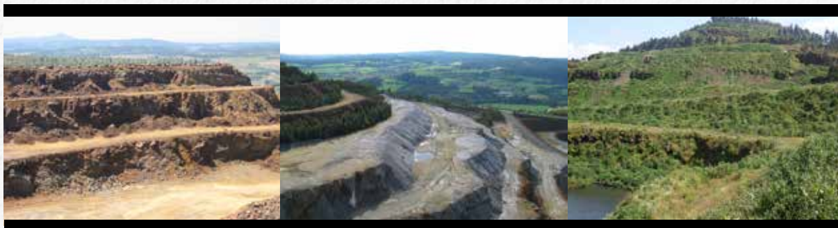
Fig 2.- A partir de 1998 comenzaron a utilizarse diferentes tipos de Tecnosoles (ándicos, sambaqui, reductores, eutróficos, etc) en la mina de cobre de Touro. (EXPLOTACIONES GALLEGAS, TRATAMIENTOS ECOLOGICOS DEL NOSOESTE y Laboratorio de Tecnología Ambiental, USC).
